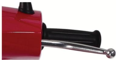
La maneta del freno trasero se utiliza para controlar la velocidad a la que se mueve la rueda trasera. Practique bien las técnicas de frenado y adaptese al sistema de frenado combinado.
