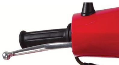
La maneta del freno delantero está en el lado derecho y se utiliza para frenar o detener el scooter. Practique bien las técnicas de frenado y adaptese al sistema de frenado combinado.
