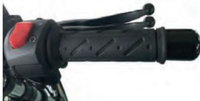
A manete de travão dianteiro encontra-se no lado direito do guidão e serve para abrandar ou parar o motociclo. Pratique bem as técnicas de travagem e adapte-se ao sistema de travagem combinado.
