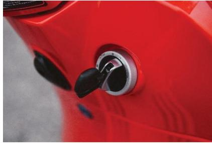
O canhão de ignição encontra-se próximo do guiador e possui 4 posições: “ON”, “OFF”, abrir compartimento do banco e bloqueio de direção.
